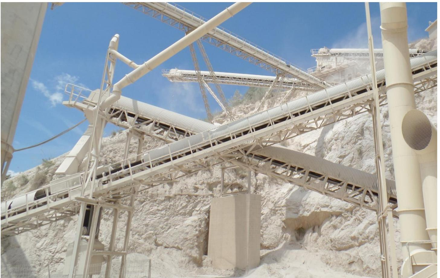
El eje del otro extremo, o tambor, suele girar accionado por la propia cinta y su función es servir de retorno. A veces, la cinta transportadora, necesita un mecanismo tensor para ejercer la fricción necesaria que permita el desplazamiento del material a transportar.
